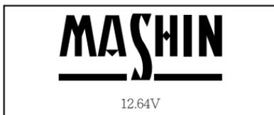
在預設情況下，開機介面的正下方為電壓顯示值，可以作為直流電壓表使用。直流電壓表測量範圍為6 - 30VDC，超過測量範圍會造成本機損壞。
